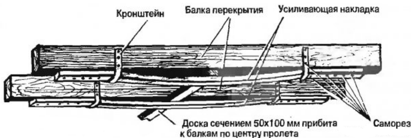
Рис. 3.4. Усиление существующих деревянных балок горизонтальными накладками
